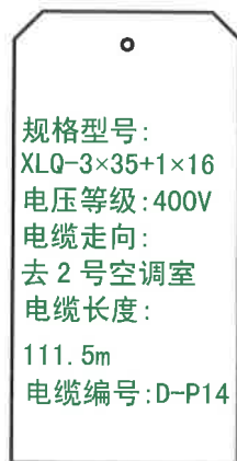
图 3.2.1-23 电缆标志牌示例
